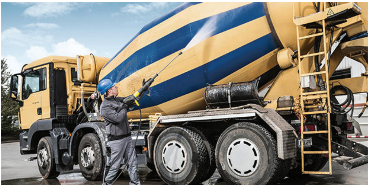
Зураг 33.Машин механизмын дугуй угаах 2-р арга: Механик гар аргаар даралтат усаар тоос шороог шүршиж арилгах /Жишээ зураг/
